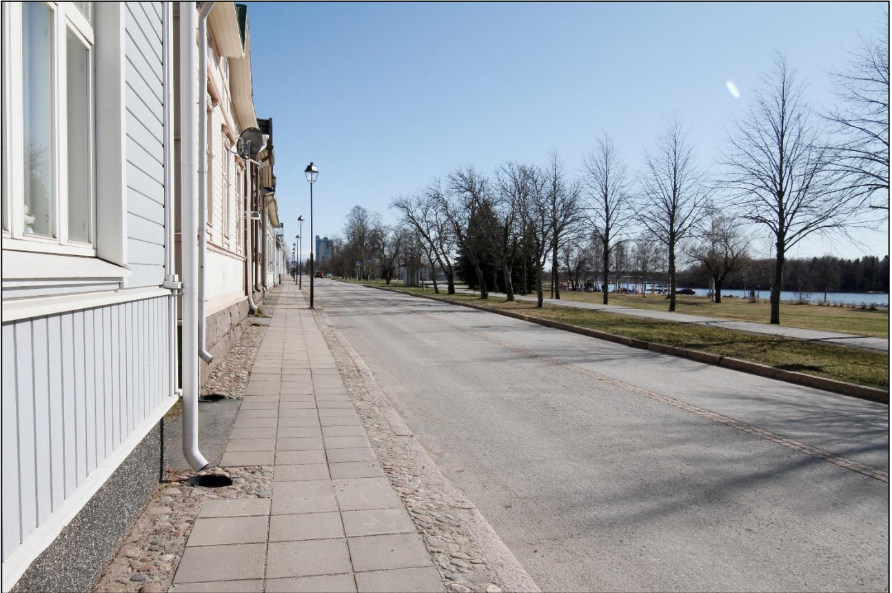
Kuva 13. Rantakatu, jonka poikkileikkaus muodostuu jalkakäytävästä, ajoradasta, välikaistasta ja yhdistetystä jalan- kulkua- ja pyöräilyväylästä. Välikaistalla on myös joitakin pysäköintipaikkoja syvennyksissä. (Kuva: Minttu Kervinen)
